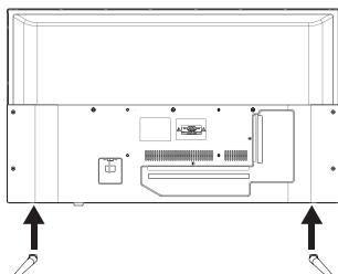
3. Закріпіть стійки за допомогою гвинтів ( входять у комплектацію приладу).
